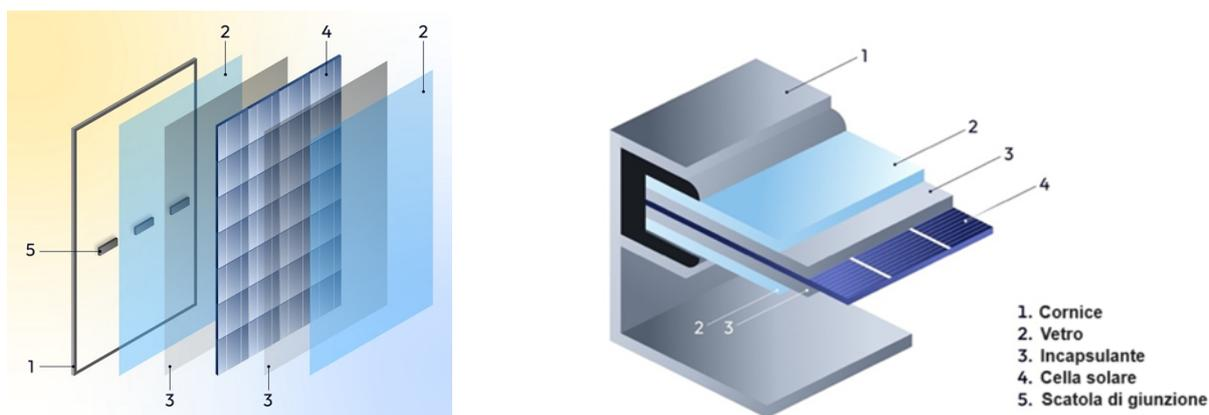
Figura 4: sezioni trasversali rappresentative dei moduli FV.
