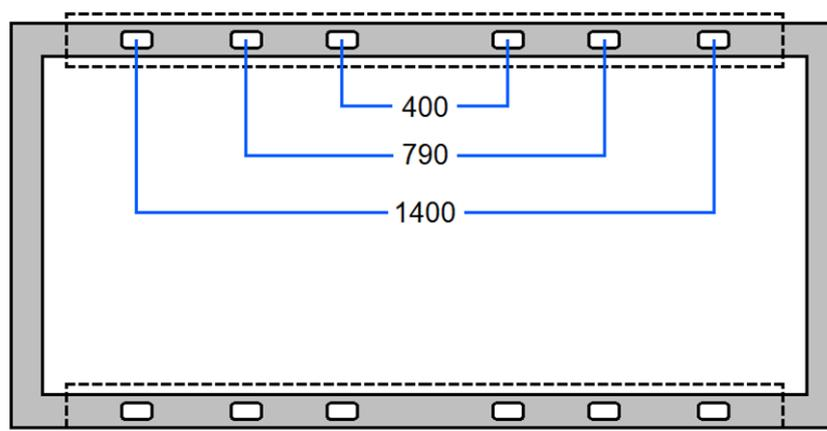
Figura 27: Posizione dei fori di montaggio della cornice.
