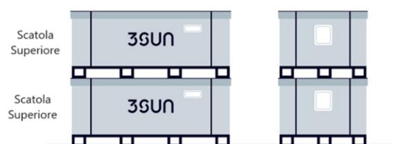
Figura 12: Non è consentito l'impilamento delle singole scatole dopo la separazione del bi-pack.
