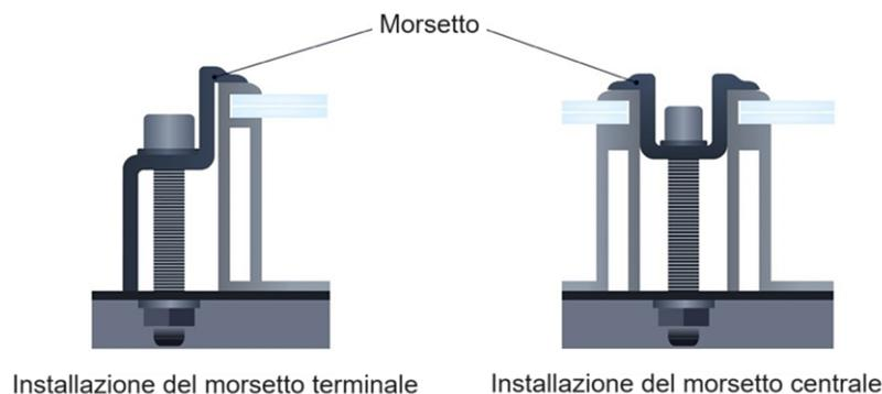
Figura 25: Esempio di installazione con morsetto.
