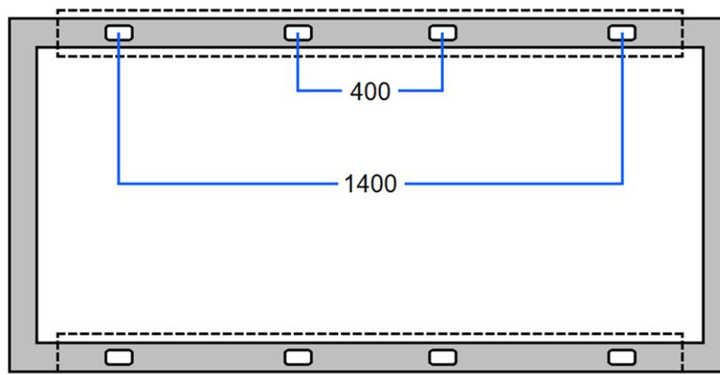
Figura 21: Posizione dei fori di montaggio della cornice.
