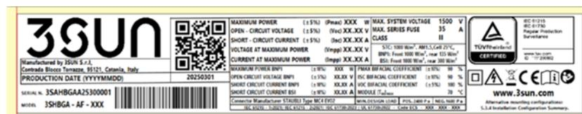
Figura 6 : esempio di etichetta di alimentazione del modulo
