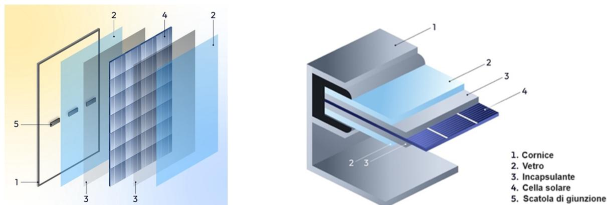
Figura 3: sezioni trasversali rappresentative dei moduli FV.
