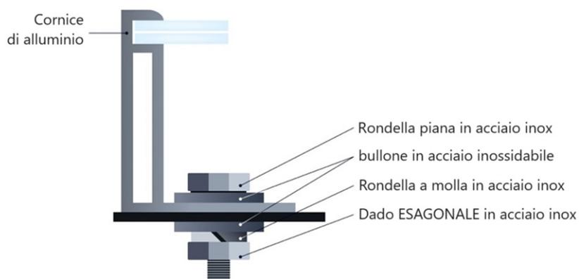
Figura 20: Modulo FV installato con metodo di montaggio a bullone.
