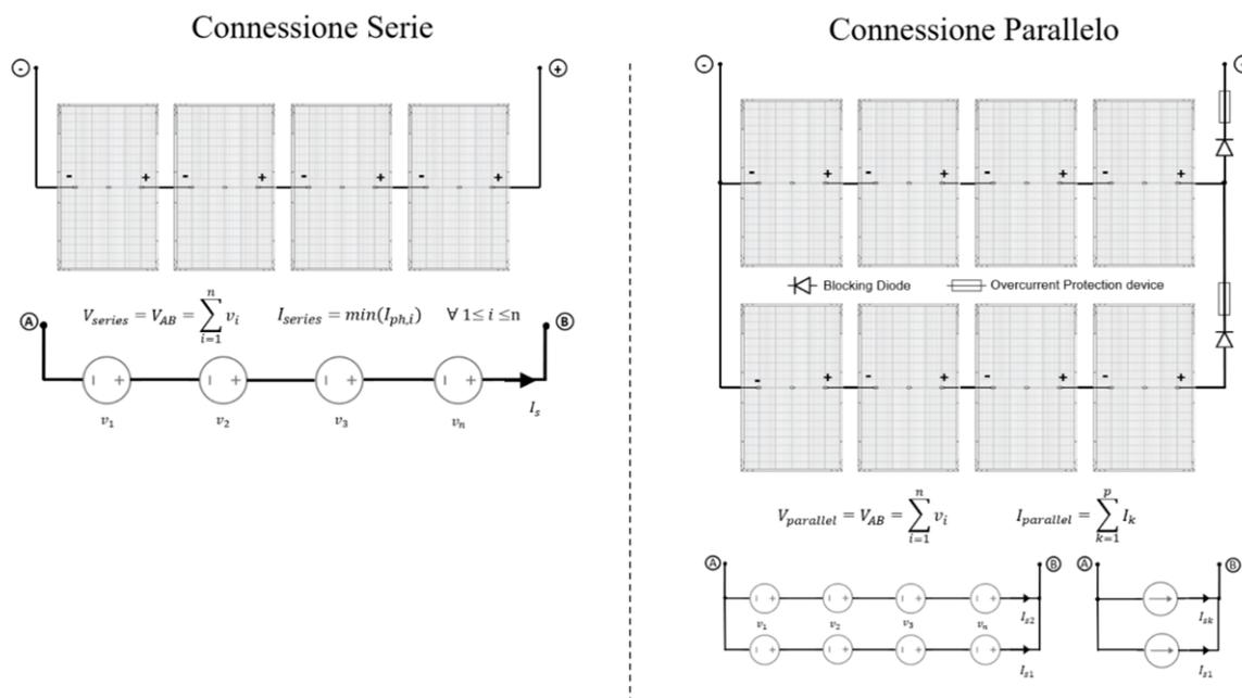
Figura 22: Schema del circuito di collegamento in serie e collegamento in parallelo
